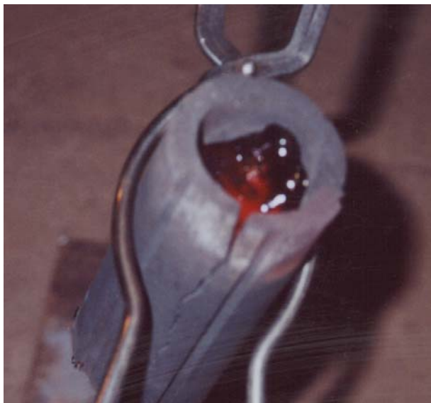
Figure 5. Molten basalt in carbon container Slika 5. Rastaljeni bazalt u ugljičnom spremniku
