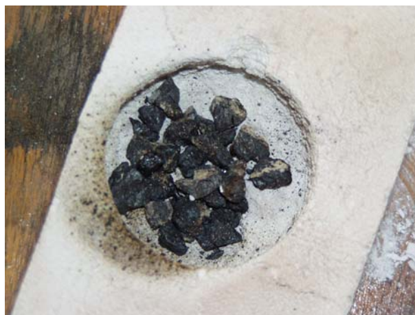
Figure 4. Rock samples after the flame action Slika 4. Uzorci stijene nakon obrade plamenikom
