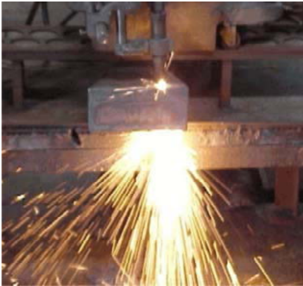
Figure 4. Practical cutting with oxy-hydrogen flame Slika 4. Prikaz praktičnog rezanja s kisik-vodikovim plamenom
